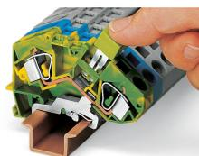
Schutzleiterklemmen lassen sich mit Querbrückern in einer Richtung (über die Klemmenrückwand) mit Durchgangsklemmen brücken. Zusätzlich zur Kennzeichnung dieser Klemmen empfehlen wir die Verwendung der gelbgrünen Querbrücker.
