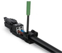
Zugentlastungsschelle mit Schraubendreher, Klingbreite 2,5 mm, auf beiden Seiten wechselseitig herunterdrücken.
