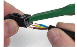
Zum Anschluss feindrätiger Leiter alle Klemmfedern mittels Betätigungswerkzeug 890-383 öffnen, und abisolierte Leiter bis zum Anschlag einführen. Eindrätige Leiter können direkt gesteckt werden.
