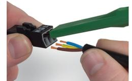
1. Abmantellänge = 30 mm (2-polig), 37 mm (3-polig), 45 mm (4- und 5-polig)
