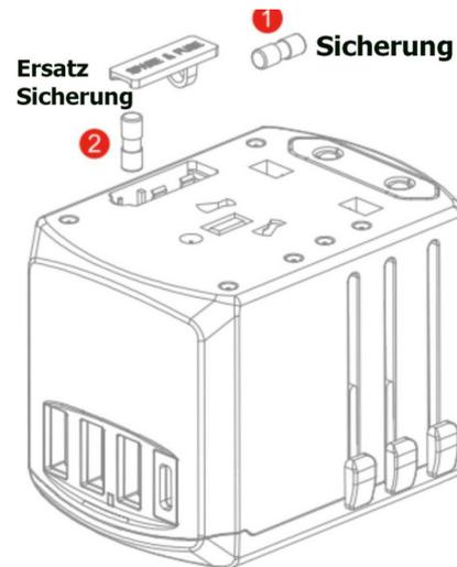
Bitte ersetzen Sie die Sicherung nur gegen den gleichwertigen 8 A Typ.
