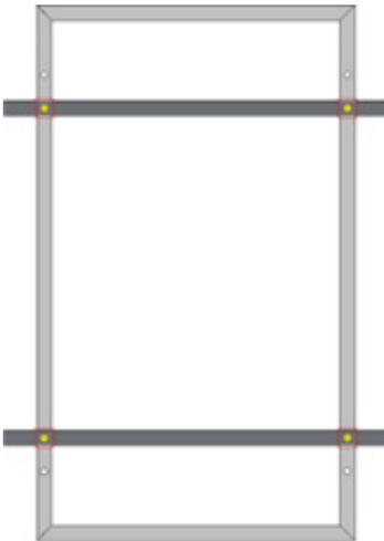
**Befestigung mit vier Bolzen und darunter liegenden Trägern**
