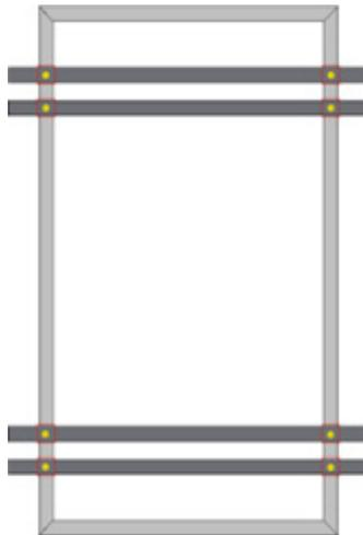
**Befestigung mit acht Bolzen und darunter liegenden Trägern**
