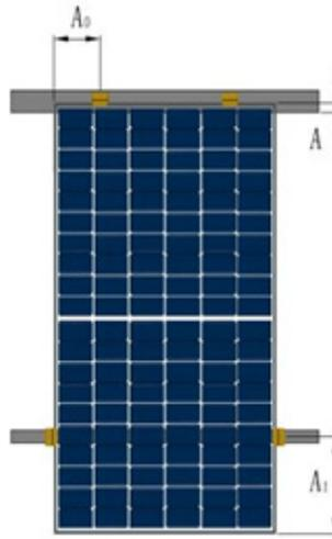
$A \geq 40$  mm;  $A_0 = 1/4$  kurze Rahmenlänge  $\pm 50$  mm;  $A_1 = 200 \sim 450$  mm
